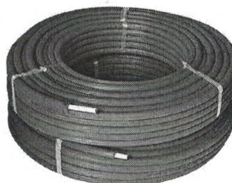
Slika 1. Izgled predizolovanih Henco višeslojnih cevi PE-Xc/AL/PE-Xc, dimenzija: Ø16x2; Ø18x2; Ø20x2 mm sa debljinom izolacije 6 i 10 mm
